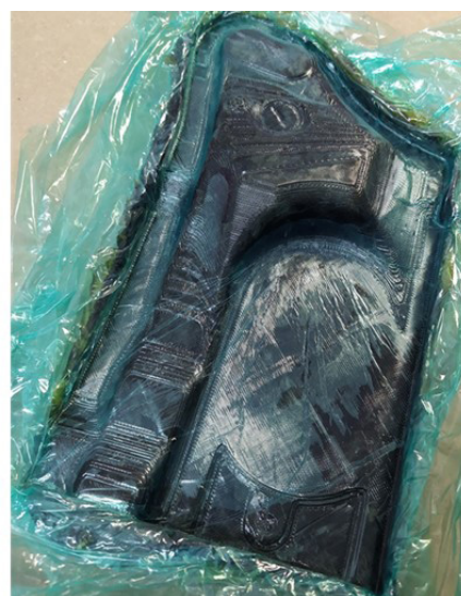
Pieza curada de preimpregnado de vinilester reforzado con fibra de carbono y film desmoldeante.
