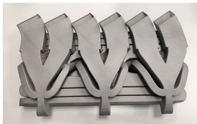
Figura 5: Actuador PJA fabricado por SLM y post-procesado.
